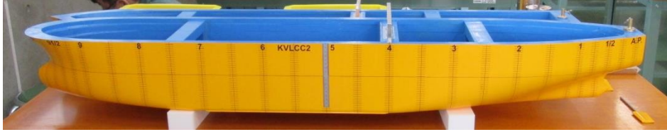
品名：肥大船型模型 規格：Lpp1.5m KVLC2
